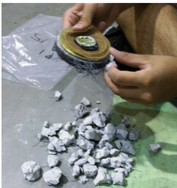
Figura 9 - Coleta das fibras de aço após o esmagamento dos pedaços de corpo de prova para separação das fibras aderidas.
