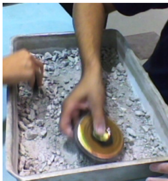
Figura 10 - Fibras de aço sendo coletadas com ímã e manualmente de maneira simultânea.
