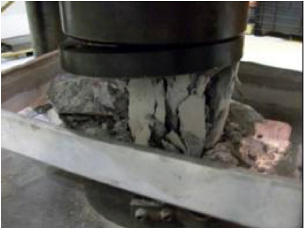
Figura 3 - Esmagamento do corpo de prova na prensa sendo mantido dentro de uma bandeja para evitar perda de material.
