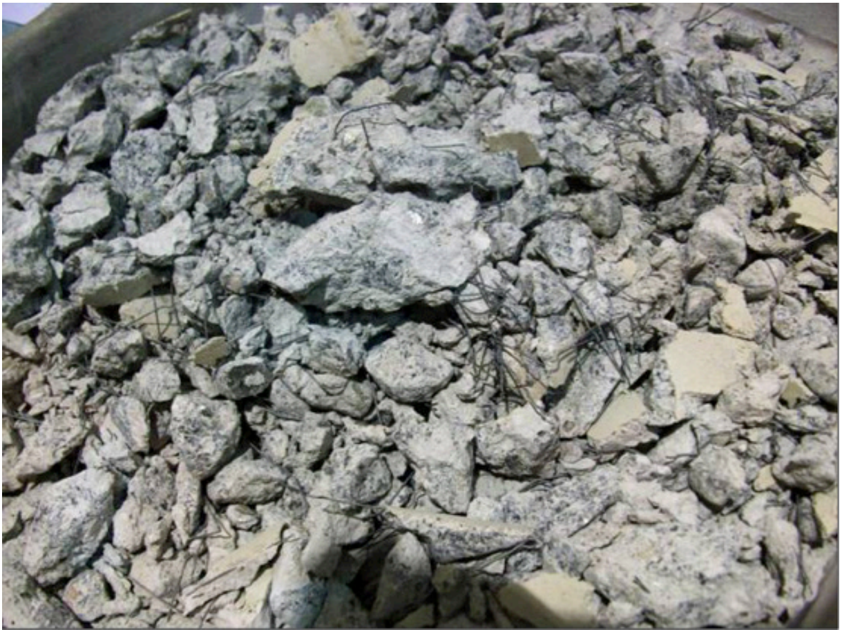
Figura 4 - Corpo de prova de concreto com fibras de aço ao final da etapa de esmagamento.
