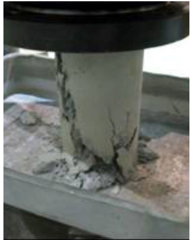
Figura 2 - Esmagamento do corpo de prova na prensa sendo mantido dentro de uma bandeja para evitar perda de material.
